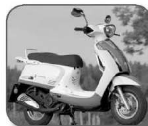
Viertakt-Emmely: mit 50- oder 125-cm 3 - Einzylindermotor
